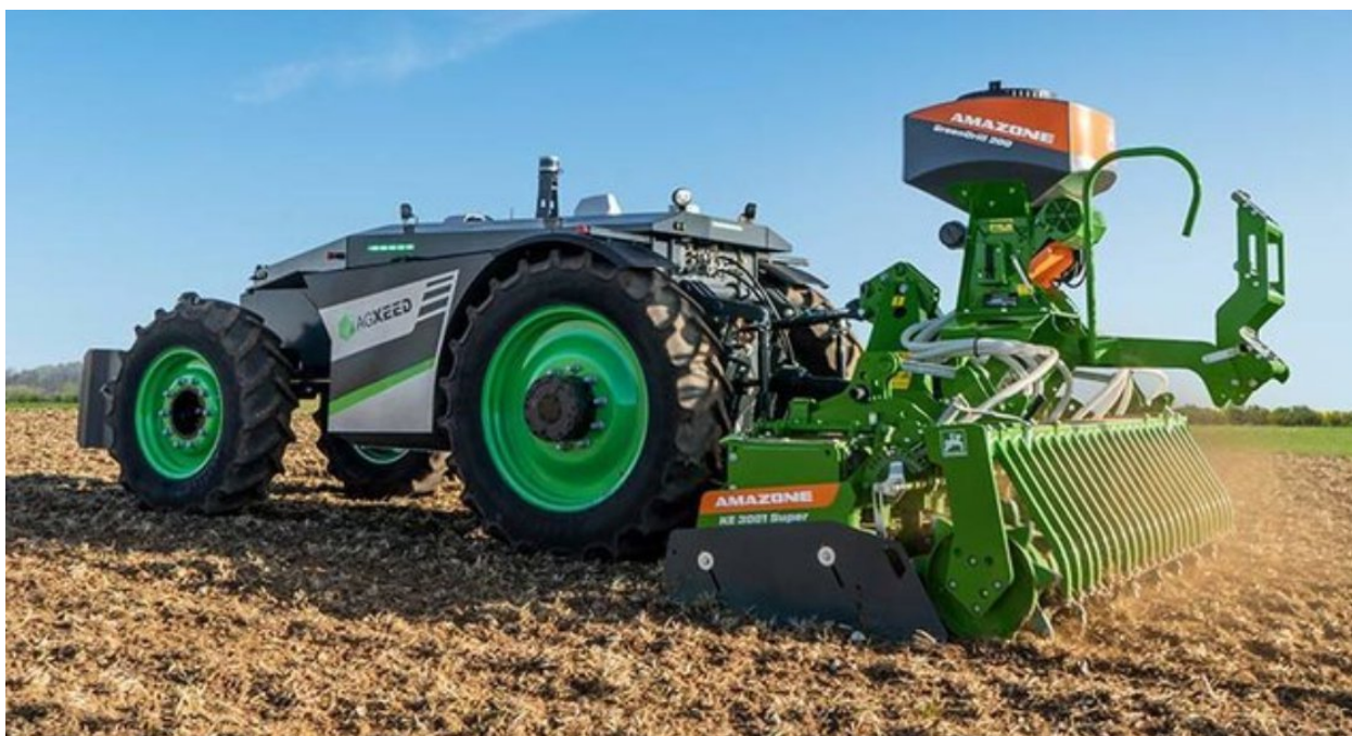
Рисунок 2.13 – Автономный трактор AgBot 2.055W4 компании AgXeed
