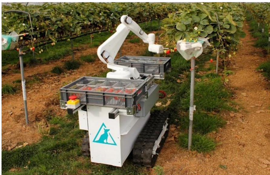
Рисунок 2.17 – Автономная роботизированная платформа на гусеничном ходу для сбора клубники
