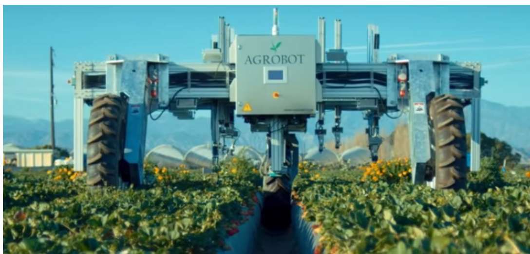
Рисунок 2.18 – Роботизированная машина Agrobot E-series для сбора клубники
