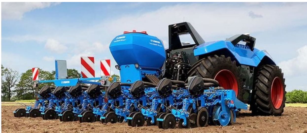
Рисунок 2.14 – Автономный трактор Lemken Krone Combined Powers
