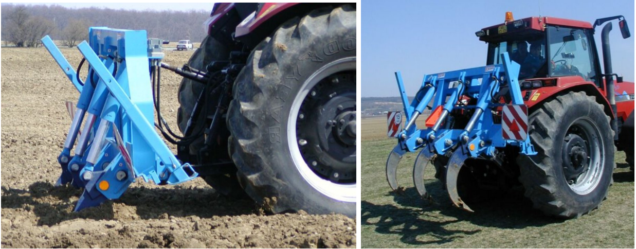
Рисунок 1.4 – Чизель-глубокорыхлитель фирмы Farmet
