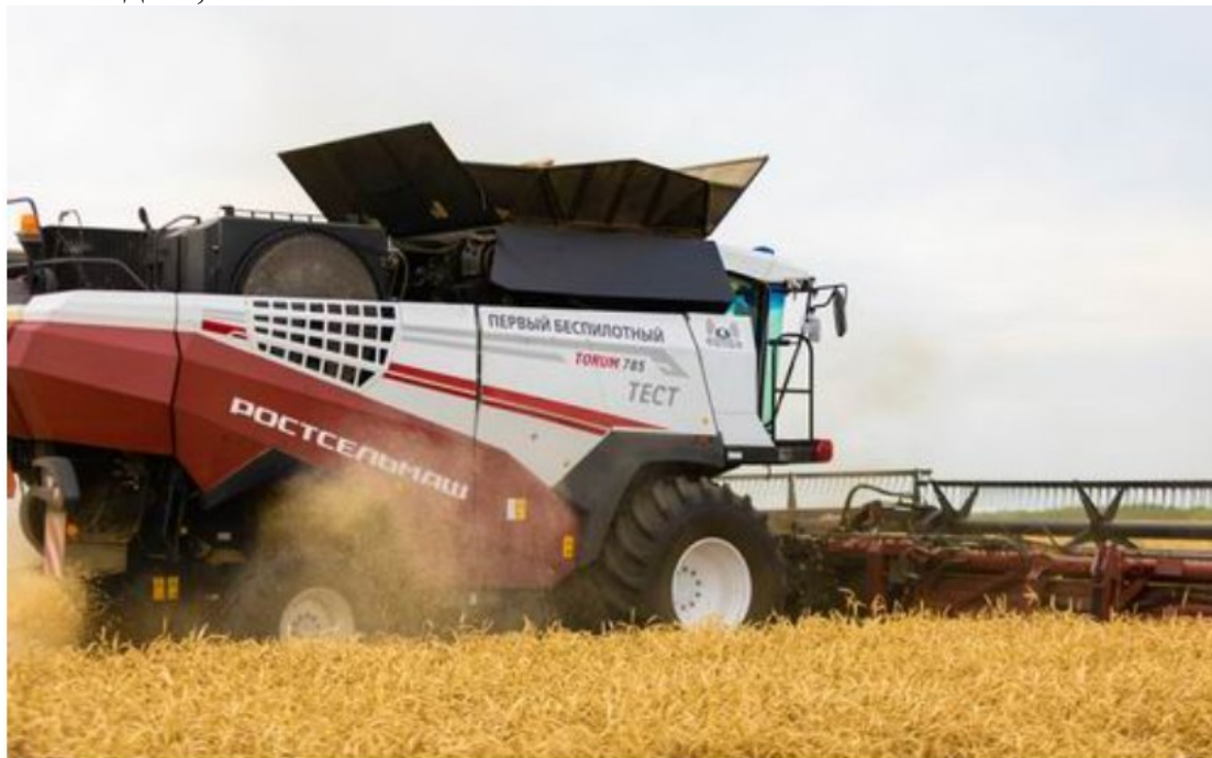
Рисунок 2.19 – Беспилотный комбайн TORUM 785 (РОСТСЕЛЬМАШ)
