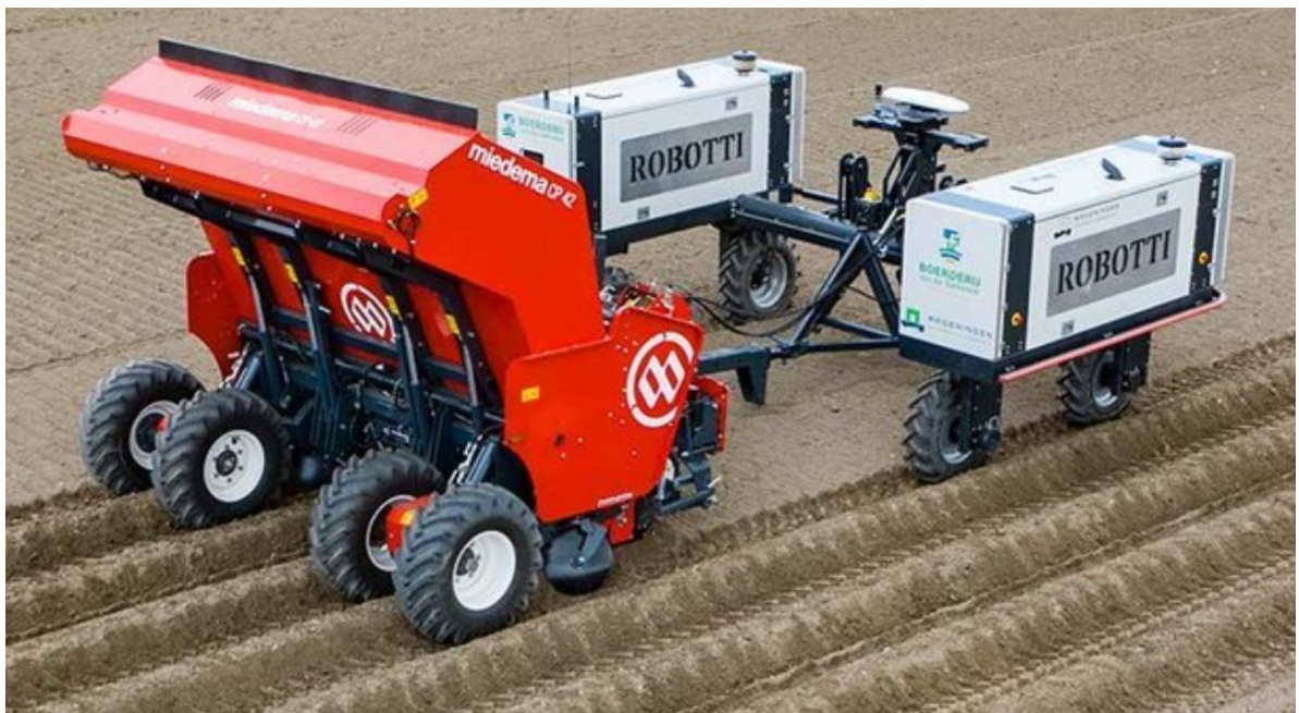
Рисунок 2.12 – Орудийный транспортер Agrointelli Robotti
